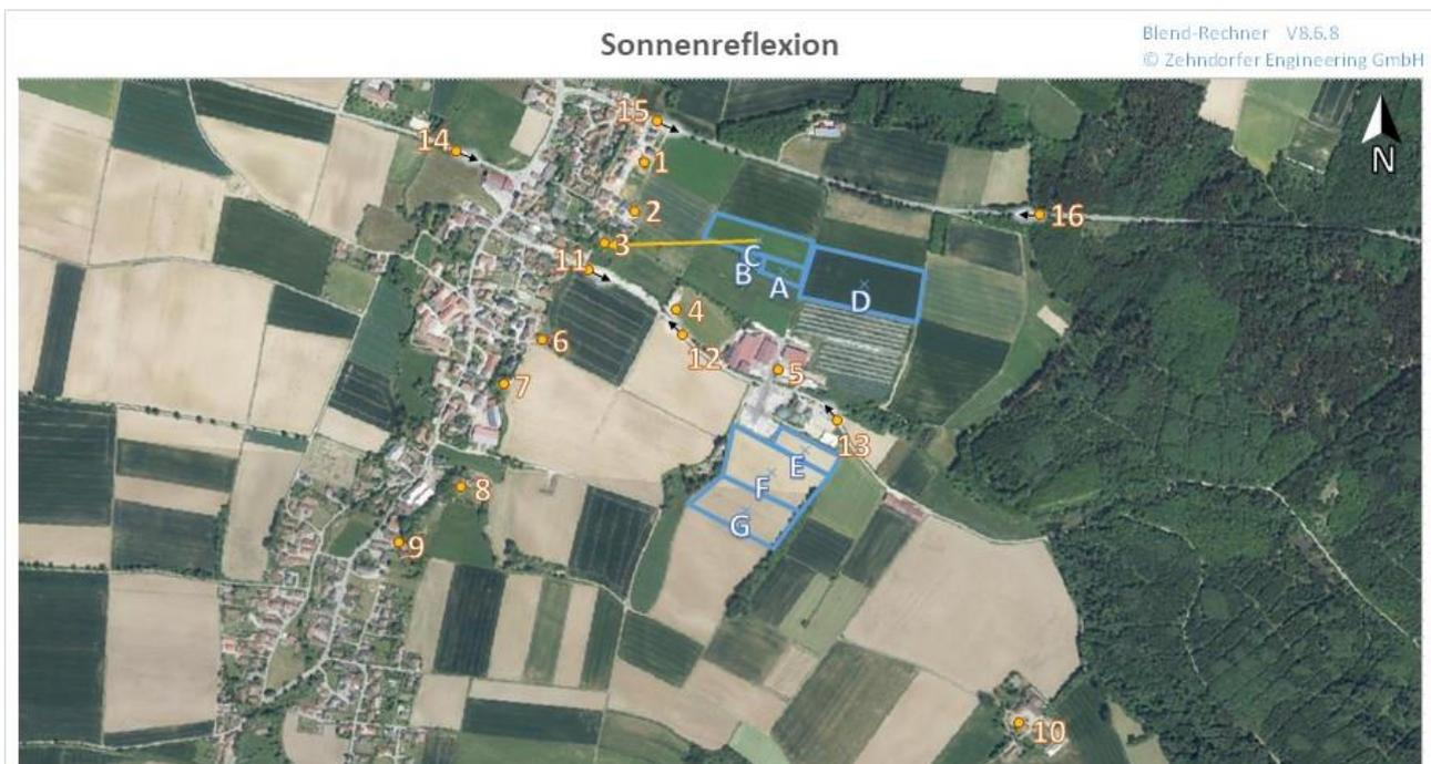
Abbildung 4 zeigt die Lage der Immissionspunkte (IP) und des PV-Feldes. Die Immissionspunkte wurden unter dem Kriterium ausgewählt, dass eine Sichtverbindung zur Vorderseite der PV-Module gegeben sein muss.
